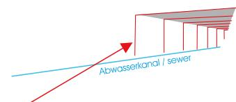
Eindringendes Grundwasser läuft an der durch D8710 abgedichteten Folie in den am Boden befindlichen Abwasserkanal.
